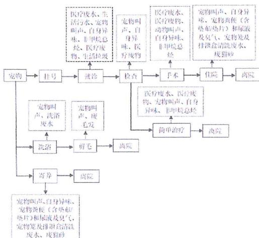
图1 营运期工艺流程及产污流程图
