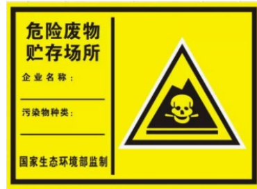
图 4-1 危险废物贮存场所标牌示例
